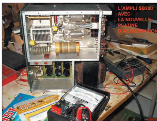
Figure 1: L'amplificateur ouvert et modifié.
