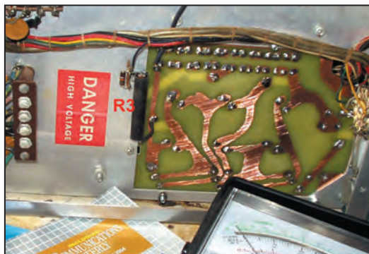
Figure 4: Le nouveau circuit imprimé mis en place.
