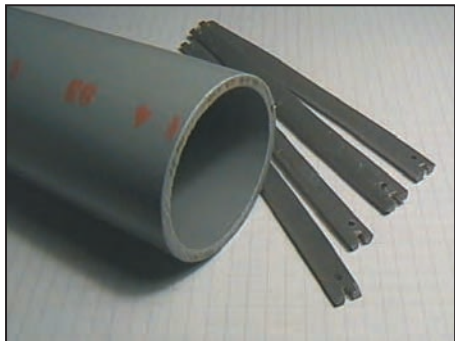
Figure 7: Matériau pour la découpe des entretoises.
