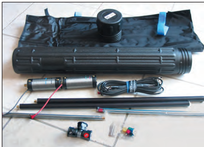
2 - L'ensemble des éléments composant l'antenne.
