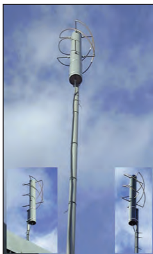
Fig. 11 - Vue générale des antennes Quadrifillar Helix (GOHPO).
