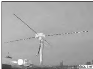
Fig. 6 - Antenne Turnstile (a).
