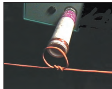
Fig. 2 - Mesure de la fréquence de résonance du dipôle.
