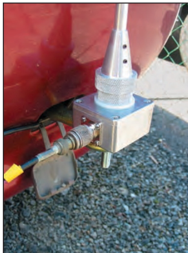
3 - Mise en place de l'embase de l'antenne.
