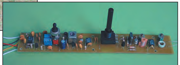
8 - La platine électronique du récepteur.
