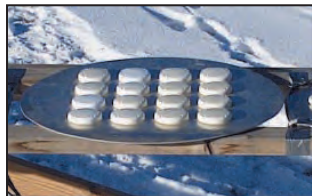
3 - Antenne directive électronique pour récepteur GPS.
