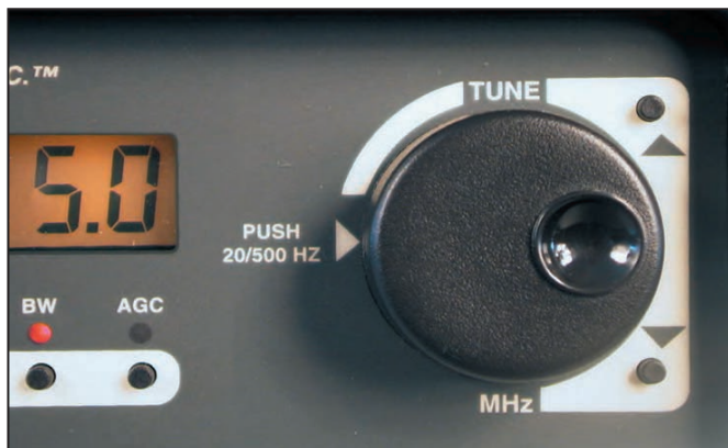
4 - En poussant sur le bouton TUNE, on modifie le pas d'incrément.
