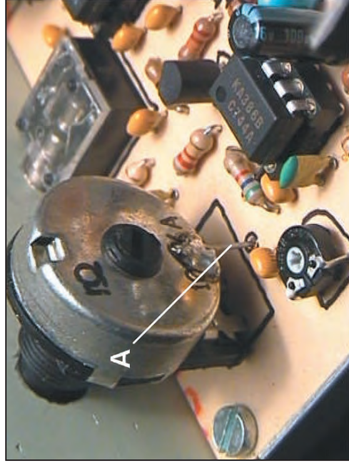
Figure 6 : Fixation du potentiomètre R3 sur le circuit.
