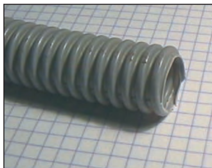
Figure 2: Gaine électrique annelée pour faire des supports.
