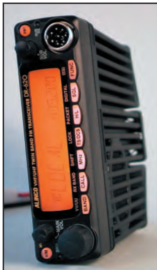
2 - Le panneau avant peut-être retourné de 180 degrés.
