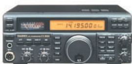
FT-840 Emetteur/récepteur HF base/mobile 100 W
