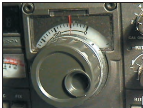
Figure 7: Mesure de la fréquence à un ou deux kHz près.
