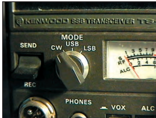
Figure 6: Mode CW, USB ou LSB pour écouter le signal de notre oscillateur.
