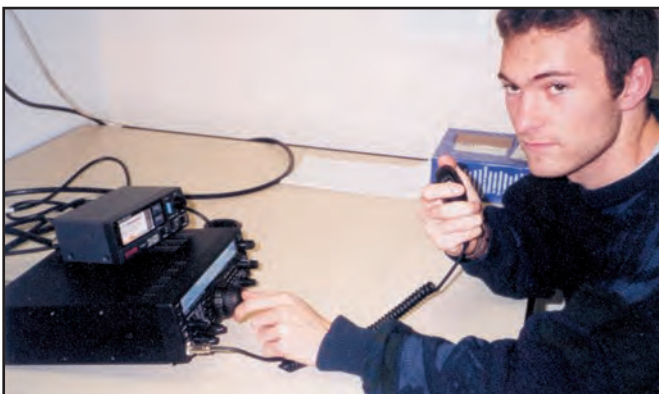
Edouard Devernisy s'essaie au trafic avec la station du club composée d'un Yaesu FT-847, d'un tripleur MX 2000 et d'une antenne V2000 (50/144/430 MHz).
