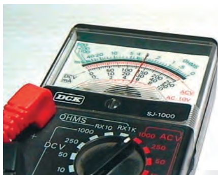
Figure 3: Un simple contrôleur à aiguille peut servir de détecteur de HF.
