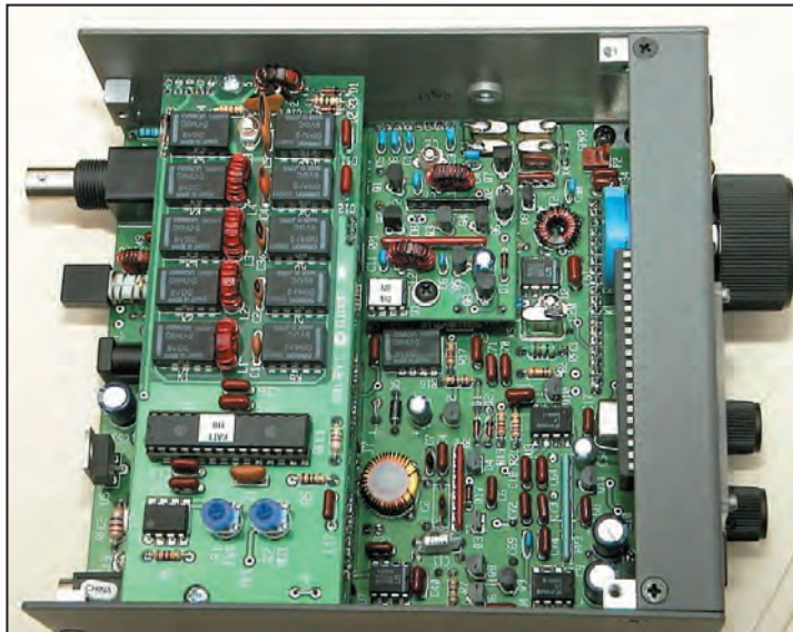
Les deux platines installées dans le K1.
