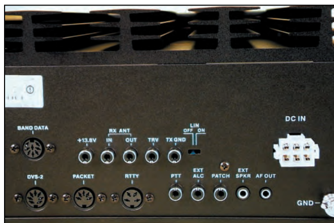
Cette vue partielle du panneau arrière montre le profil du dissipateur.
