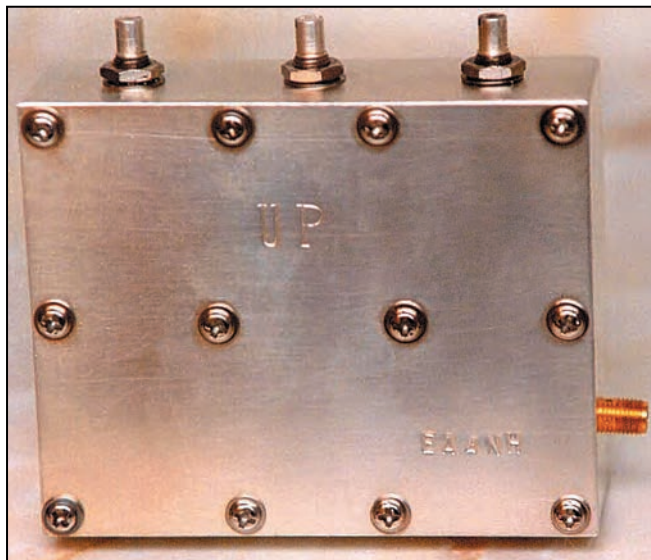
Figure 2 : Vue du filtre terminé. Ici l'entrée (non visible) se trouve sur la plaque du fond et la sortie sur la plaque latérale gauche.
