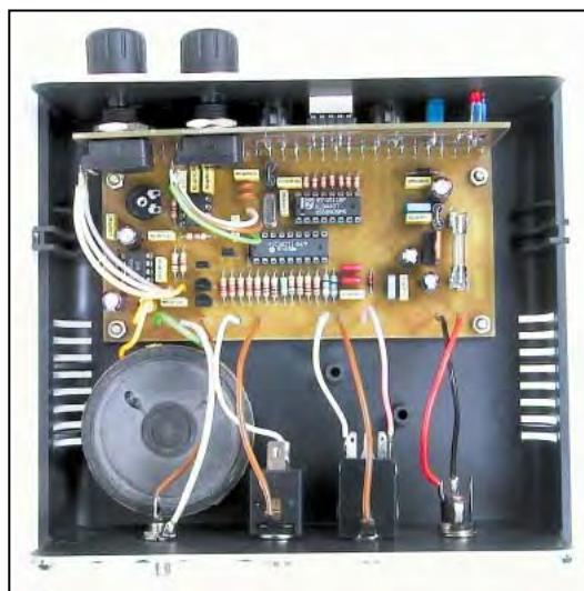
La mise en place des deux platines dans le coffret.
