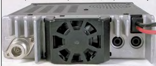
Une seule prise antenne sur le panneau arrière, le duplexeur est intégré.
