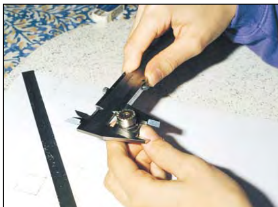
Photo 2 - Déterminer le diamètre des trous à percer.
