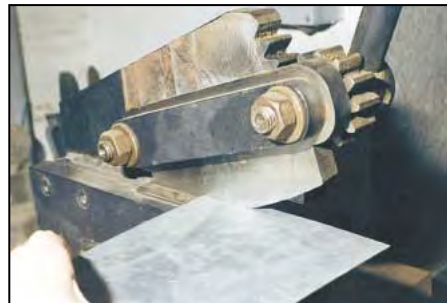
Photo 5 - Découpage de la tôle.
