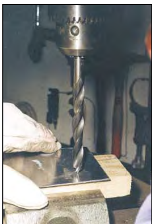
Photo 7 - Attention aux doigts en perçant de la tôle.
