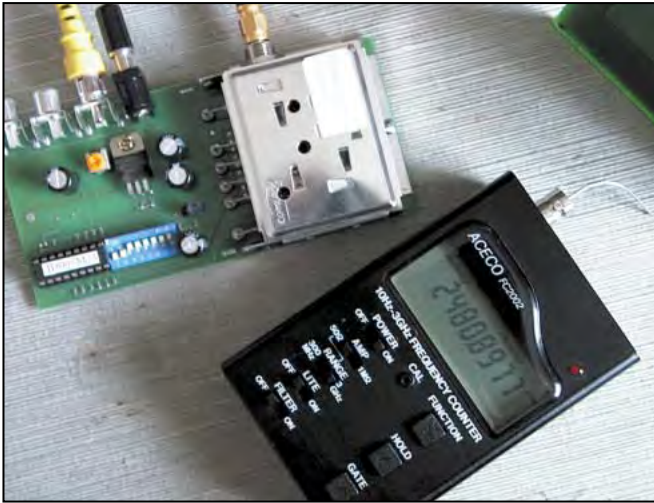
Test de la dérive sur 2 heures de fonctionnement !
