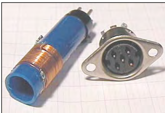
Photo 3 - Une bobine interchangeable.
