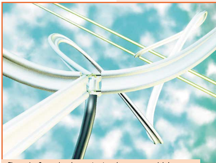
Figure 6 : Connexion des quatre trombones au coaxial de descente d'antenne.
