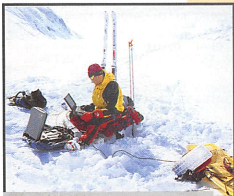
Un OM bien équipé avec terminal INMARSAT alimenté par panneaux solaires.
