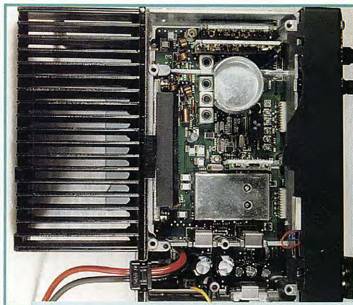
Un gros dissipateur évite le bruit d'un ventilateur.
