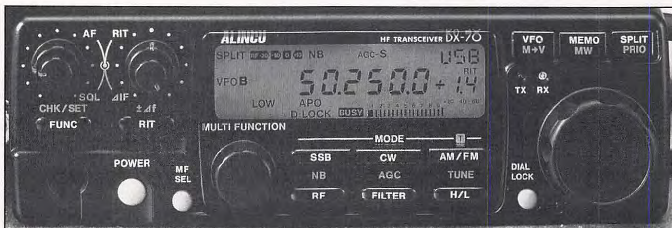
Dans le détail, et à l'échelle 1, la face avant du DX-70.
