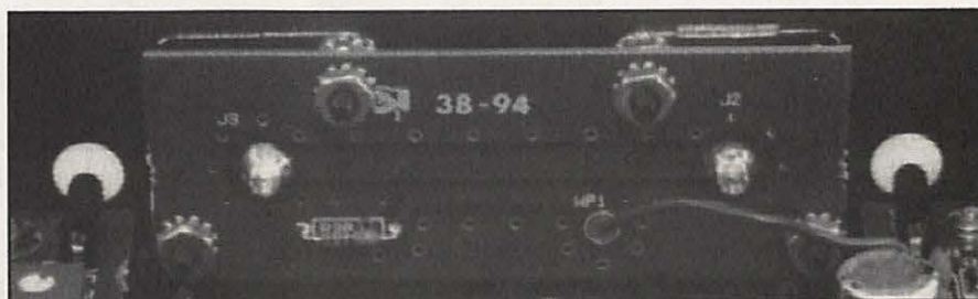
Le coupleur de mesure du DM-1.
