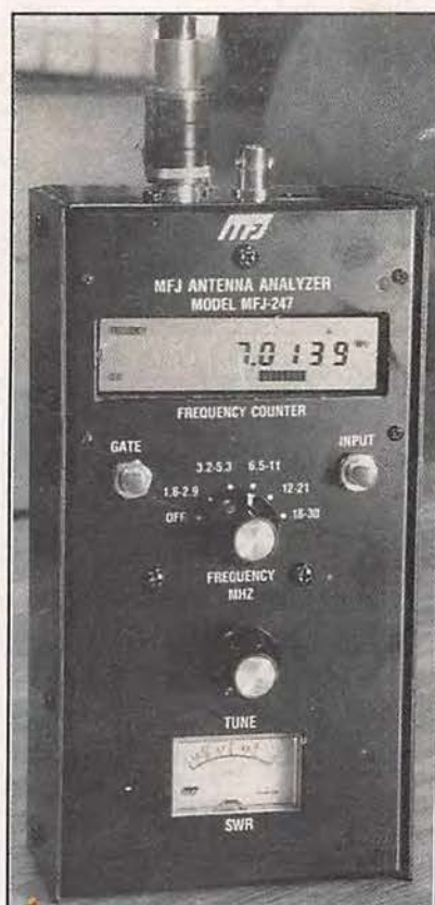
Mesure directe, sans tarage du TOS avec indication de la fréquence.
