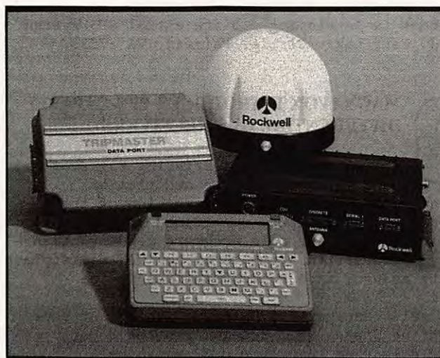
Figure 3 : localisation / messagerie satellite l'équipement nécessaire.
