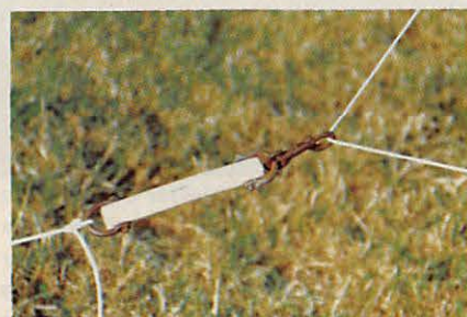
Le tendeur de la delta loop.
