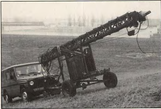
Une ancienne grue transformée en pylône pour les besoins radioamateur (F6IMS).
