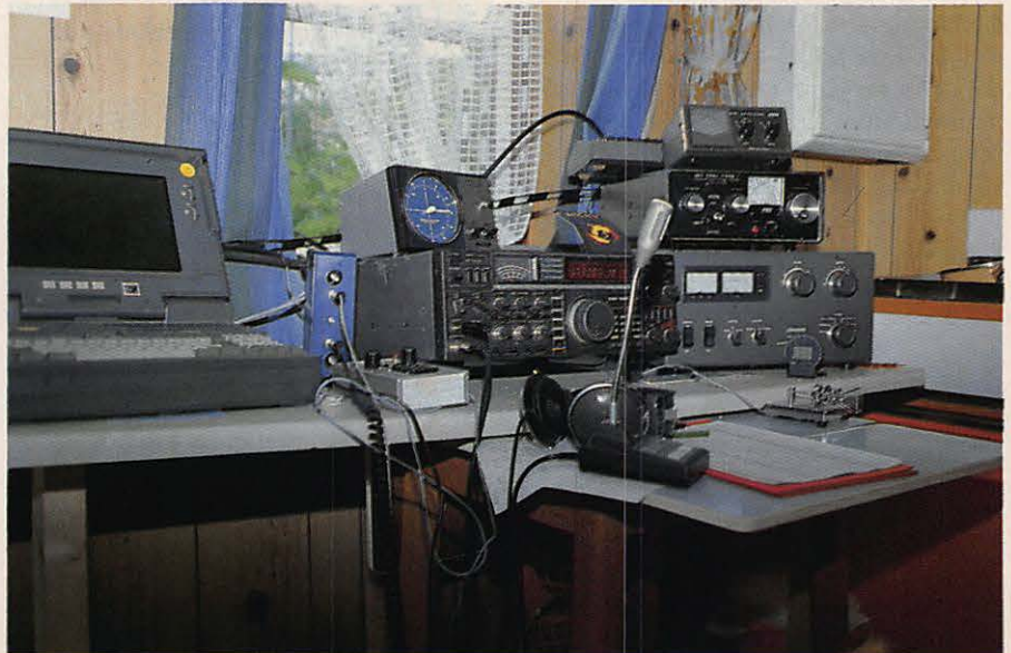
L'installation du matériel de gauche à droite: l'ordinateur portable, la boîte de dérivation BF, le lanceur d'appel, l'IC765, le TL922, la boîte d'accord VHF et le TOS wattmètre Daiwa.
