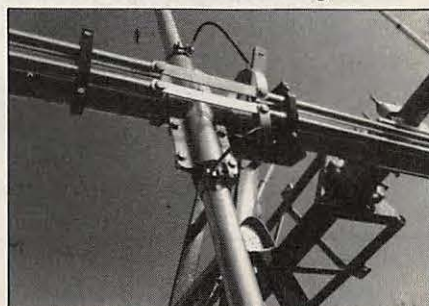
Fixation du driver avec le balun et la ligne de phasage.
