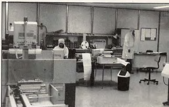
Elap : machine à poser les CMS.
