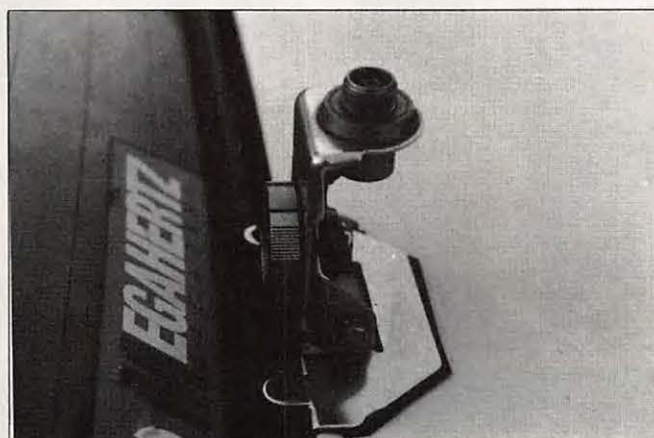
Photo 1 : L'embase de coffre.
