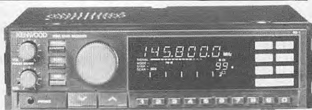
RZ1 - le scanner transformé en récepteur AM-FM - 500 kHz à 905 MHz sans trou
