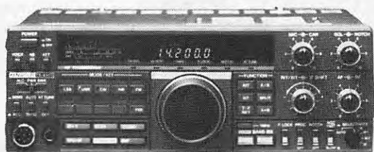
TS 440 SP* - TS 440 SPP* TRANSCIVEUR DÉCAMÉTRIQUE - TX : bandes amateurs - RX : 150 kHz à 30 MHz - AM/FM/BLU/CW/FSK - 100 W HF - 200 W PEP - IF Shift - Notch - ATT - 100 mémoires - 2 VFO - Alim. 12 V externe.
