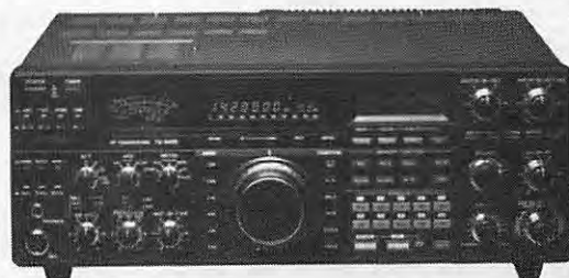
TS 940 SP* - TS 940 SPP** TRANSCIVEUR DÉCAMÉTRIQUE - TX : bandes amateurs - RX : 150 kHz à 30 MHz - Tous modes - 100 W HF - 200 W PEP - Alim. secteur incorporée. UNE RÉCEPTION INCOMPARABLE!
