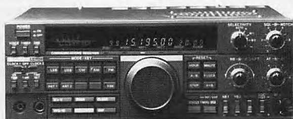
R 5000 RÉCEPTEUR - Couverture : 150 kHz à 30 MHz - 108 à 174 MHz avec VC 20 en option - AM/FM/BLU/CW/FSK - IF shift - Notch - Pitch CW - 4 sélectivités FI. UN RX DE TRAFIC A COUVERTURE GÉNÉRALE.
