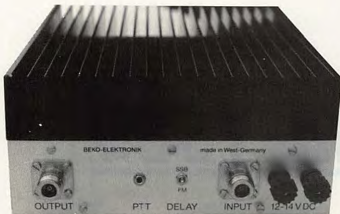
La face arrière de l'ampli. Remarquez l'inverseur SSB/FM.
