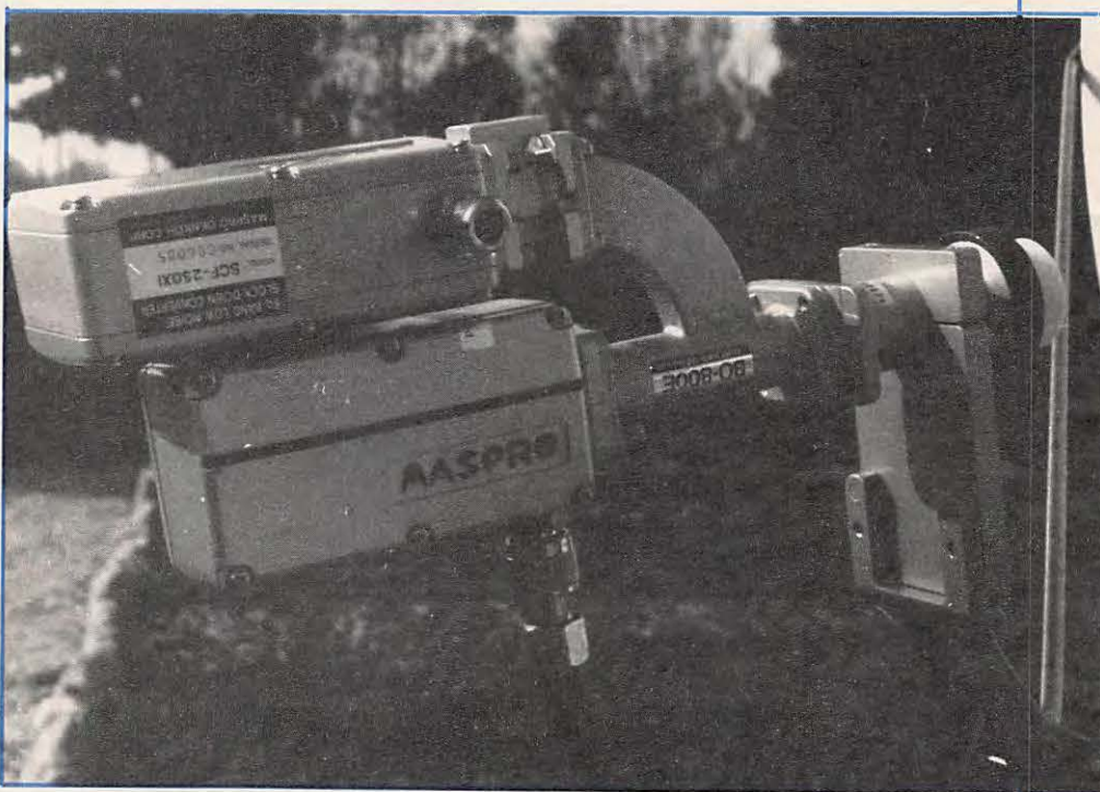
Tête MASPRO : SCE 750X pour ECS-SCF 250x1 : pour Télécom 1 + orthocoupleur + FEED.
