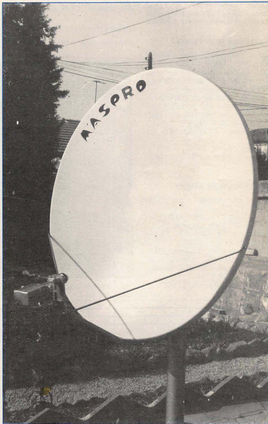
La parabole offset de 1,20 m, modèle BSQ - 120 E.
