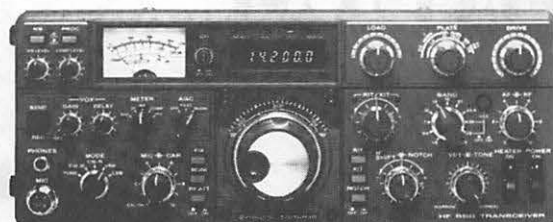
Emetteur-récepteur TS 830 S Emission-réception Bandes amateurs Tubes au final - 220 V - USB/LSB/CW.
