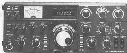
Émetteur-récepteur HF TS 530 Sp Émission réception. Bandes amateurs. SSB/CW. Alimentation secteur incorporée.
