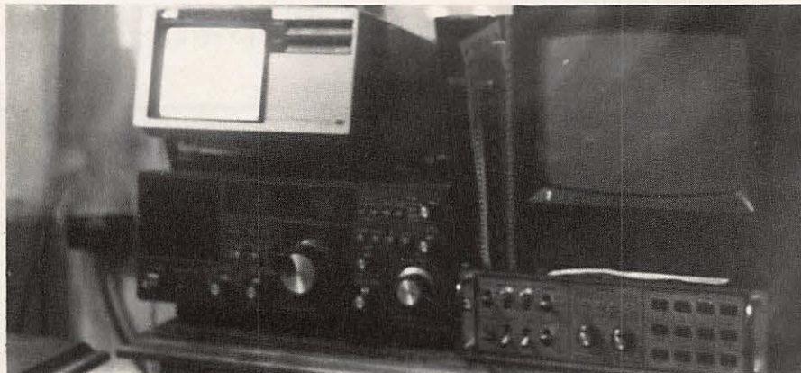
Le récepteur TV JVC 610 PF PAL/SECAM. A droite le FRG 7700 avec son moniteur 21 cm NEC et en-dessous le décodeur RTTY TONO 350.
