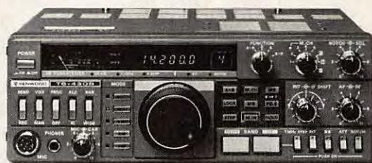
Emetteur-récepteur TS 430 SP* Tout transistor. LSB/USB/CW/AM et FM en option. 100 W HF Emission bandes amateur. Réception couverture générale 12 volts.
