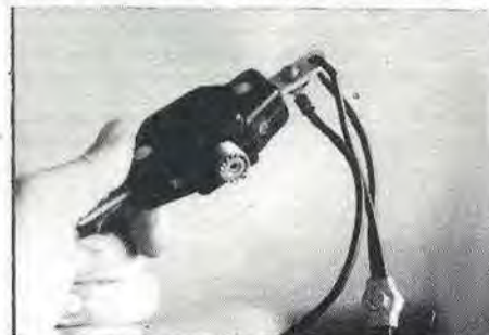
Arrivée du câble coaxiale sur SO239
