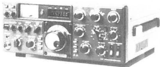
Émetteur-récepteur HF TS 530 S Émission réception. Bandes amateurs. SSB/CW. Alimentation secteur incorporée.
