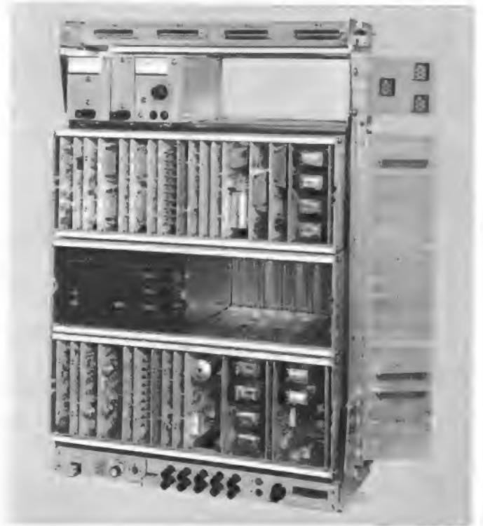
◀ Bild 6. Anzeigefeld älterer Bauart. Einige typische Fernwirkungen sind z.B.: Bildvorstufe ein - aus, Diapositiv ein - aus, Empfangsseitig ersatzschalten, Quitting, Sender gestört, Modulator gestört, Sicherheitsausfall, Pilot fehlt, Meldefehler, Tank leckt, Netzersatz-Anlage ein, Ausfall der Meldeleitung, Feueralarm
