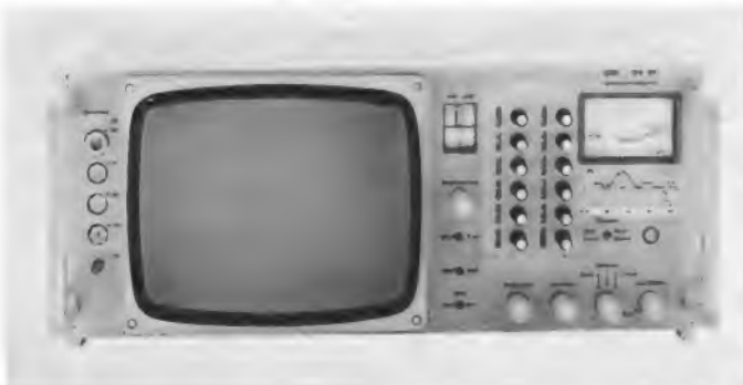
▲ Bild 2. Antennenmeßgerät mit Drucktastensatz und Bildmonitor (W. Sihn)
