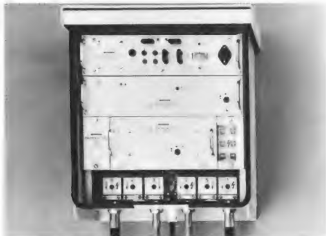
Bild 7. ▶ Aus Standardeinschüben bestehende Kopfstelle einer GGA-Anlage von Siemens
