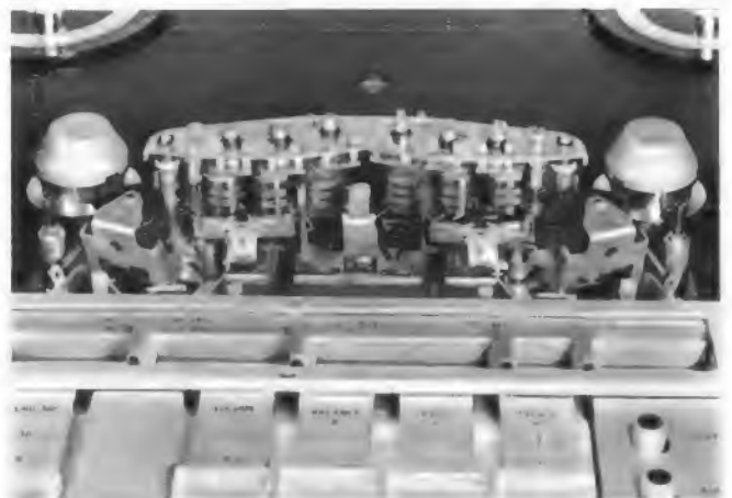
Bild 2. Blick auf die Kopfträgerplatte mit sechs Magnetköpfen für Reversionsbetrieb und Hinterbandkontrolle in beiden Richtungen. Neben den beiden frei beweglichen Umlenkrollen sind die zwei Gummiandruckrollen zu erkennen, vor denen sich die an ihrem oberen Ende in der Kopfträgerplatte gefaßten Tonwellen befinden. Bei der Rechtsfahrt des Bandes werden die drei rechts liegenden Magnetköpfe benutzt, bei der Linksfahrt die links liegenden, so daß die zwei Löschköpfe in der Mitte zu liegen kommen. Vor den Aufnahme- und Wiedergabeköpfen sind die Andruckfilze mit Mu-Metallabschirmungen angeordnet
