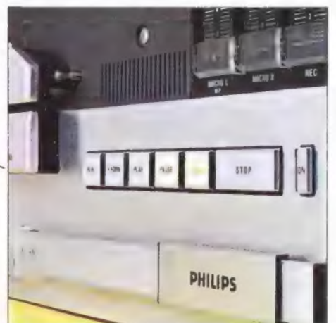
N 4418 Durch die neuartige Laufwerk-Konzeption können alle Bandlaufaktionen und die Aufnahme jetzt elektronisch gesteuert werden. Rückmeldung der eingegebenen Funktion erfolgt durch Aufleuchten der betreffenden Taste.
