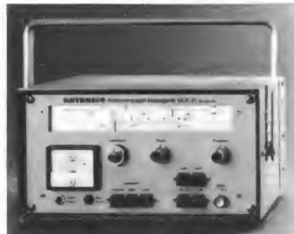
Bild 1. Antennenpegel-Meßgerät nach CCIR-Norm für VHF und UHF (Kathrein)
