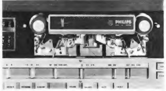
Bild 4. Die Bandklebeschleife kann nach Abheben der unteren Abdeckung benutzt werden. Sie hat in ihrer Mitte einen Schrägschlitz zum exakten Schneiden des Bandes. Die links und rechts daneben sichtbaren schwarzen Balken sind nach vorne hochklappbare Bandklammern
