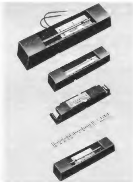
Curtis-Betriebsstundenzähler mit in Stunden geicherter Skala. Die Haube mit der Quecksilber-Kapillare ist abnehmbar und umgekehrt wieder aufsetzbar (Vertrieb: Dira-Technik, Bergisch-Gladbach)
