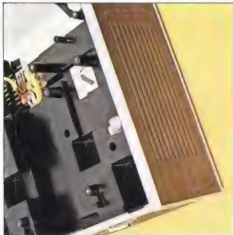
N 4418 Die stark reduzierte Mechanik erlaubt erstmals, geschlossene Lautsprecherboxen in das Gerät einzubauen.
