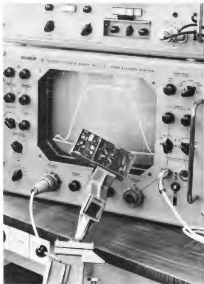
Bild 7. Selektionskurve des Bild-Zf-Bausteins. Die Selektionskurve ist in logarithmischem Maßstab aufgetragen. Die Selektion ist oberhalb 48 MHz bis über den gesamten Band-III-Bereich besser als 65 dB
