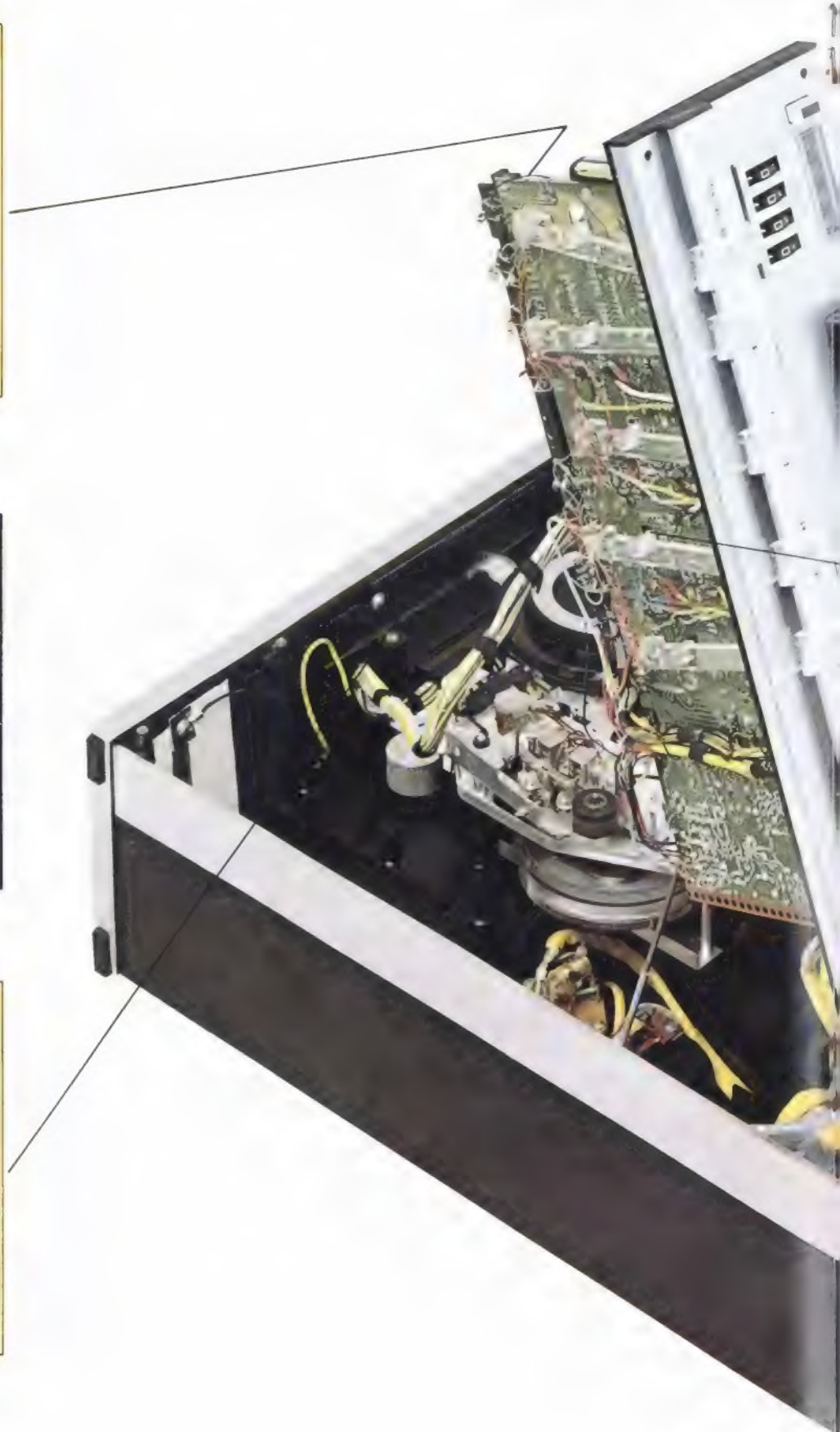
N 4418 Deutlich erkennbar die paarweise Anordnung gleicher Module.
