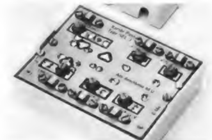
Bild 11. Der Mehrfach-Paß für alle Rundfunk- und Fernsehbander blendet sämtliche anderen Frequenzen mit großer Sperrtiefe aus (A. Strobel)
