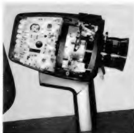
Bild 9. Innenansicht der neuen Bauer C 10. Sie enthält neben einigen Transistoren auch eine IS (Aufnahme: Knaut)
