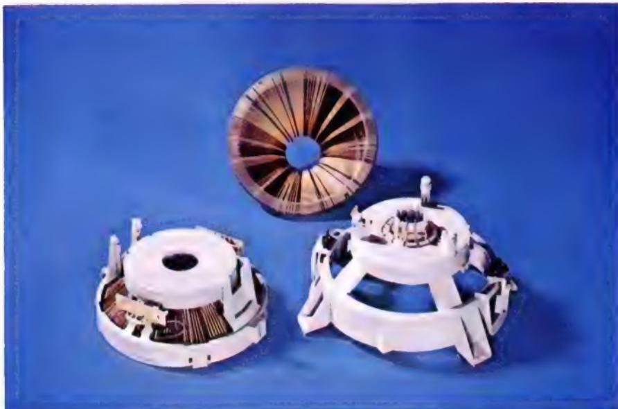
Bild 2. Hauptbestandteile des Ablensystems
