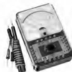
20 000  $\Omega/V$  = 4000  $\Omega/V$  Wechselspannung/Spiegelskala Klasse 1,5 mit Oberlastungsschutz, Kapazitätsmessung 126 x 85 x 33 mm, 49 Bereiche, Gerät kompl. mit Tasche, Prüfschnüre und Anleitung inkl. Batterie ..... **124.- DM**
