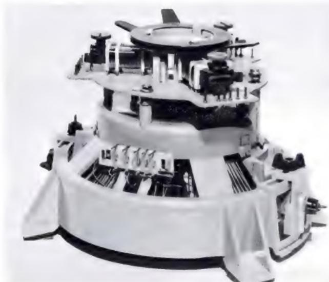
Bild 3. Ablenssystem mit Radialkonvergenz
