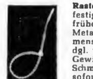
**Rasterdrahtschleife,** wird als Nylonbestreifer überall dort eingesetzt, wo früher Schnüre, Bänder, Drähte, Metallbänder od. ähnl. zum Zusammenschließen, Knüpfen, Binden u. dgl. verwendet wurden. Merkmale: Gewicht 0,15 g, Zugkraft 11,3 kg, Schmelzpunkt ca. 254°C. Befestigt sofort ohne Werkzeug, Rasterstellungen von 25-3 mm 10 St. DM -50
