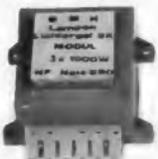
**Typ L 1000-3 M.** Lichtorgelmodul für 3 Kanäle. Leistung pro Kanal 1000 W/220 V. Einzeln oder über eine 3-Kanal-Frequenzweiche LW-100 verwendbar. Vergossenem Modul 58 x 58 x 46 mm hoch. Herausgeführte Lüsterklammern. Nach VDE-Vorschrift ..... **DM 44,-**
