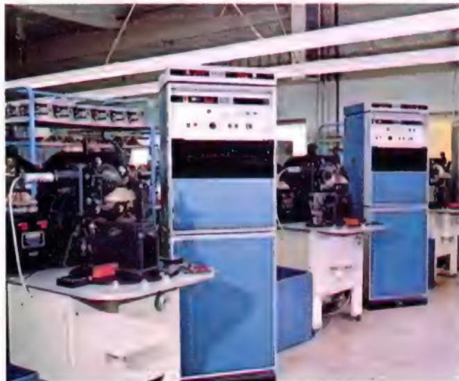
Bild 4. Wickelautomaten mit numerischer Steuerung
