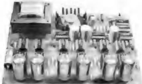
Alle Bauteile sowie der Trafo sind auf der Printplatte montiert. Die 5-V-Versorgungsspannung kommt aus einem Leistungsspannungsregler (IC) I.M 335. Anschlüsse für Weckeinrichtung sind vorhanden. Zum Entstören etwa vorhandener Netzstörungen empfiehlt sich das Netzstörfilter B 84102-C 30 vorzuschalten. Fassungen für ICs und Röhren sind im Bausatz enthalten. Als Quarzeitbasis empfehlen wir unsere QZB 1 M.
