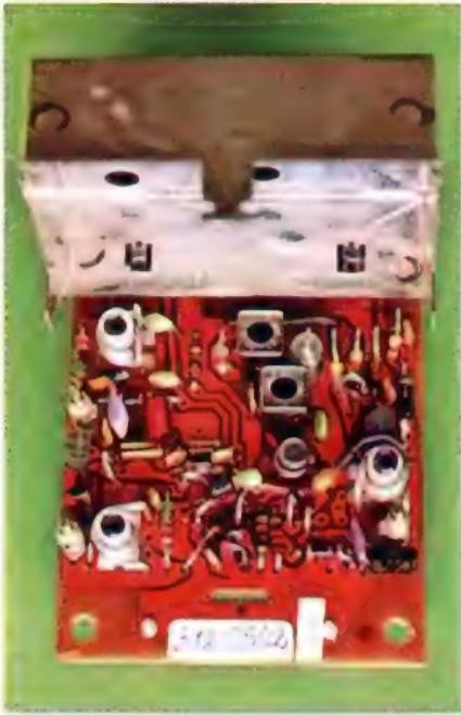
◀ Bild 2. Konstruktiver Aufbau des Tuners auf einer Leiterplatte (Aufnahme: Kriebel)
