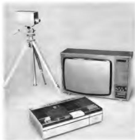
Bild 5. Loewe-Opta VCR-Gerät Optacord 700 Color. Im Hintergrund Aufnahme-kamera und Wiedergabe-Farbfernsehgerät
