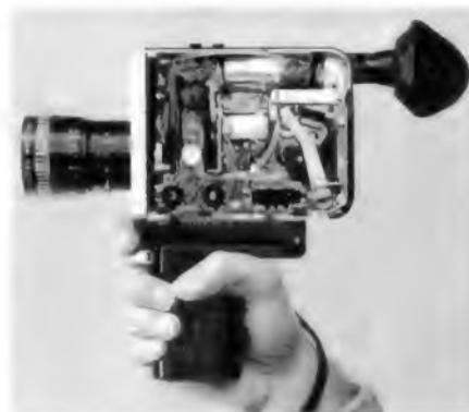
Bild 10. Nizo S 80 der Braun AG. Auch hier ist der große Anteil an Elektronik zu erkennen
