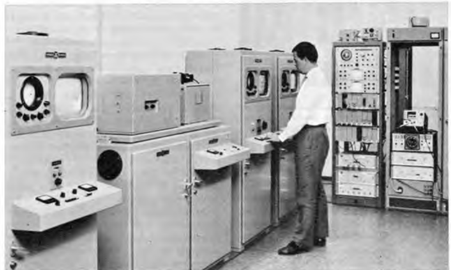
Bild 1. Normwandler der Deutschen Bundespost in der Satelliten-Bodenfunkstelle Raisting für die Umsetzung der US-Farbfernsehnorm nach NTSC (525 Zeilen/30 Bildwechsel) in die europäische Norm (625 Zeilen/25 Bildwechsel) nach Pal. Im Hintergrund das Gestell mit Einschüben, in denen das Farbsignal zur Normwandlung aufbereitet wird
