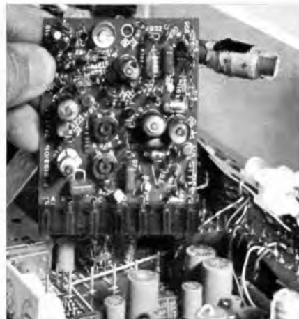
Bild 1. Der neue Stereo-Decoder von Blaupunkt ist steckbar ausgeführt und hat nur geringe Abmessungen. Außer der hier gezeigten Ausführung existiert bereits eine zweite, die durch Verwendung von Dickfilmschaltungen noch kleiner ist (siehe Titelbild)
