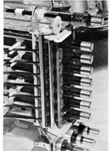
Bild 3. Sieben Programme des VHF- oder UHF-Bereichs lassen sich mit dem neuen Programmwähler Grundig-electronic speichern, der über vertikal angeordnete Sendertasten und zentrale Feinabstimmung verfügt. Eine Rundskala ist versteckt im Abstimmknopf untergebracht und läßt sich zusammen mit diesem bei der Ersteinstellung oder Umprogrammierung ein Stück weit aus dem Bedienungsteil herausziehen
