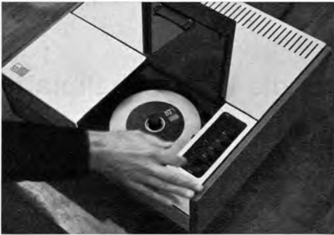
Bild 2. Filmrolle im EVR-Spieler, rechts das Bedienungsfeld mit Tasten für Vor- und schnellen bzw. langsamen Rücklauf und für Stillstand zum Betrachten eines Einzelbildes
