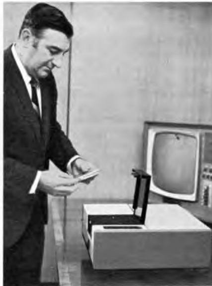
Unten Bild 3. Das Einlegen der Filmrolle mit 177 mm Durchmesser in den EVR-Spieler ist ebenso einfach wie das Auflegen einer Langspielplatte auf den Plattenspieler
