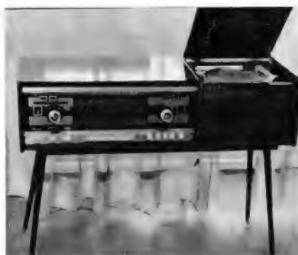
Bild 2. Phonosuper Simfonia mit UKW-Scharf-abstimmung und Sendersuchlauf, der allerdings nur im UKW-Bereich wirksam ist
