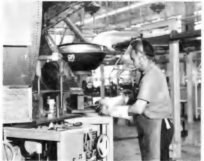
In der neuen Farbbildröhrenfabrik Ulm/Donautal von AEG-Telefunken wird die Lackschicht über den 1,2 Millionen Leuchtstoffpunkten der Lochmaskenröhre mit Infrarotstrahlern getrocknet
