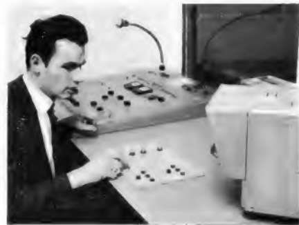
Vom Regieraum des Heilpädagogischen Institutes in Köln aus werden die Kameras ferngesteuert und die Bilder auf die Hörsäle verteilt (Werkaufnahme: Fernseh GmbH)
