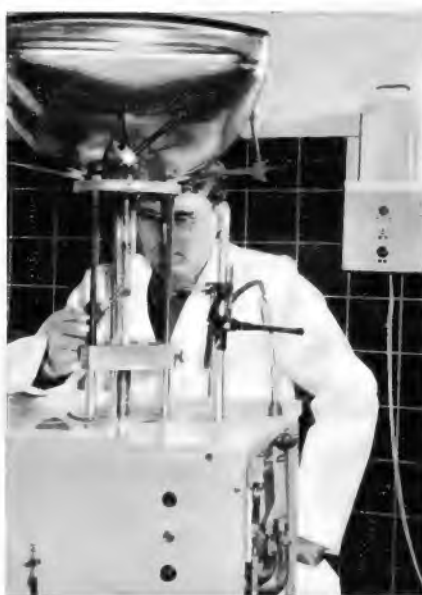
Bild 2. Zusammenschweißen des Halses mit dem Preßteller bei der Firma Teloa-Bildröhren
