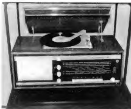
Bild 3. Phonosuper Gamma mit Farbspieleinrichtung, links hinter dem Zierrgitter. Je nach Musikcharakter und Lautstärke ändern sich Farbtöne und Helligkeit (Aufnahme: Dennewitz)
