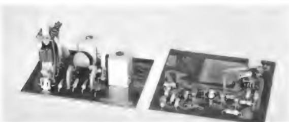
Vergleich des Versuchsaufbaus eines spulenlosen Ton-Zf-Teils für 250 kHz (rechts) mit einem in herkömmlicher Schaltungstechnik (links)
