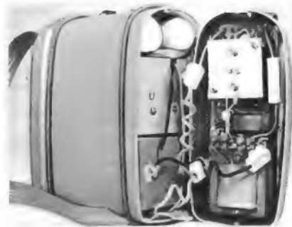
Bild 6. Einbauübersicht des Blitzgerätes in die Tragetasche
