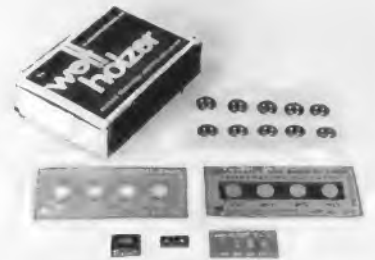
Die hellen Punkte auf den Temperaturplättchen färben sich bei Erreichen der aufgedruckten Temperaturwerte schwarz
