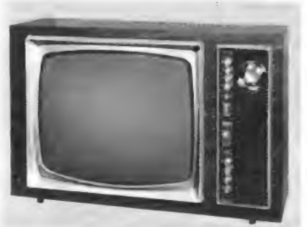
Rechts: Bild 2. Typischer Zwainormen-Fernsehempfänger (405/625-Zeilen, VHF/UHF) aus der heutigen englischen Produktion mit 47-cm-Bildröhre. Preis: umgerechnet 795 DM einschließlich Verkaufssteuer
