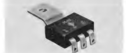
Durch den neuen TAB-PAC Leistungstransistor, der mit einer einzigen Schraube in verschiedenen Lagen montiert werden kann, wird das Befestigungsproblem elegant gelöst.
