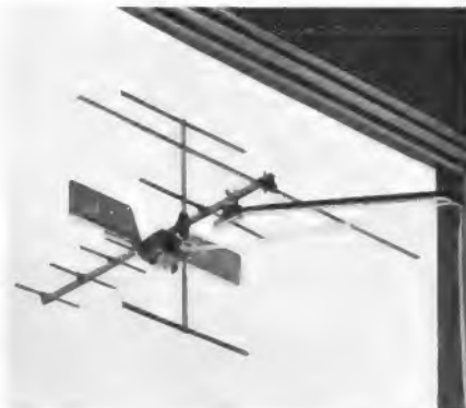
Die Kombinationsantenne Fesa F 208 wird mit Hilfe eines Kugelschalengelenkes am Fenestertträger befestigt. Die Länge der Antenne beträgt 60 cm, die des Trägers 54 cm
