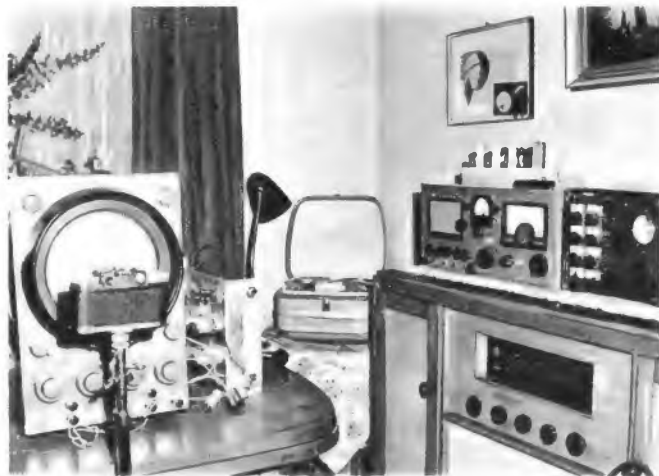
Bild 3. Die Satelliten-Bild-Empfangsanlage in der Amateurstation des Verfassers. Das auf dem Oszillografenschirm gezeichnete Bild hat eine Größe von 9 cm x 9 cm. Bei der Aufnahme ist das Kameraobjektiv 21 cm vom Schirm entfernt
