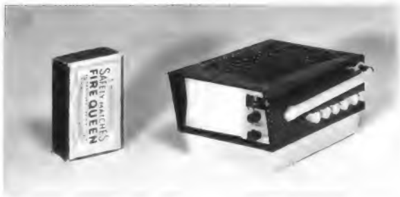
Links: Bild 3. 5-cm-Batterie-Fernsehempfänger von Sinclair, Modell Microvision
