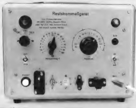
Bild 1. Frontansicht des Reststrommeßgerätes. Zur Anzeige ist ein empfindliches Gleichstrom-Voltmeter anzuschließen
