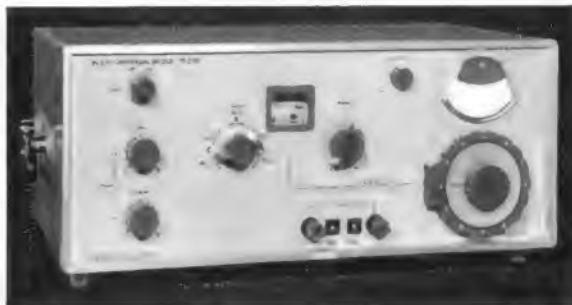
Bild 8. Das Marconi-Gerät TF 2701 ist eine Differentialüber-träger-Meßbrücke, die sich unter Anwendung der in Bild 7 gezeigten Methode zum Messen der Betriebsinduktanz eignet. Mit ihr kann man im Gegensatz zu anderen ähnlichen Brücken Serien- oder Parallelinduktanzen messen
