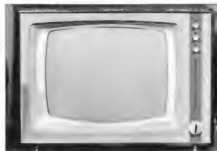
Bild 2. Exportgerät Staßfurt T 205 mit 47-cm-Bildröhre für OIRT-Norm (825 Zeilen, 6,5 MHz Bild/Tonträger-Abstand). Das Modell trägt noch eine Schutzscheibe vor der Bildröhre und hat keinen UHF-Teil
