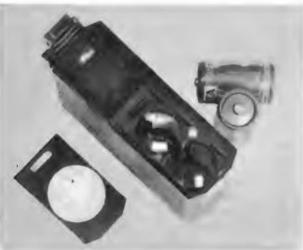
Metz-Mecablitz 116 S mit leerem Batterie-fach. Die beiden Trockenbatterien können mit einem Handgriff ausgewechselt werden
