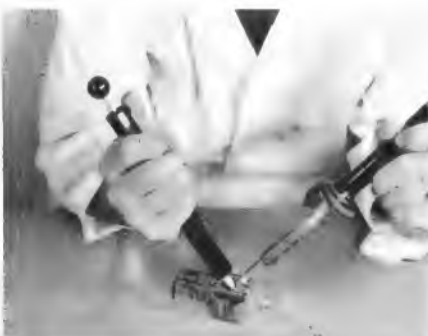
Bild 2. So werden LötKolben und Zinn-Schlürfer angesetzt, um eine Lötstelle vom Zinn zu befreien
