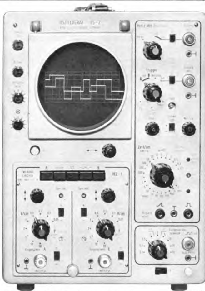
Meßoszillograf OS-2 in Stellung „Messen“
