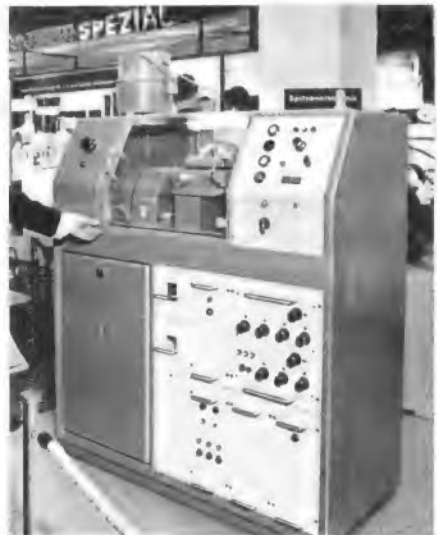
Bild 3. Schleifautomat zum Einschleifen von Wendeln in Widerstandskörper mit einer Taktzeit von einer bis fünf Sekunden (VEB Elektomat, Dresden)
