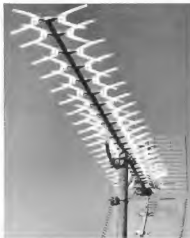
Bild 1. Die X-Color-Antennen bestehen aus X-förmigen Direktorelementen und dem Empfangssystem mit Winkelreflektor
