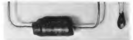
Bild 2. Größenvergleich zwischen einem normalen 20-µF-Elektrolytkondensator und einer 20-µF-Tantalperle
