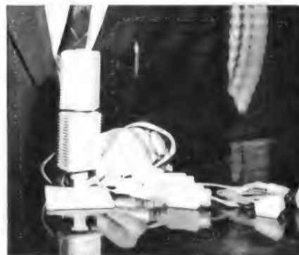
Dynamisches Stereomikrofon DZM 65 für XY-Stereofonie, zusammengesteckt aus zwei Mikrofonen Typ DHMR 85, mit zwei Schnurübertragern, die in einem gemeinsamen fünfpoligen Stecker enden
