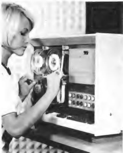
Bild 2. Programmgesteuerter Klein-Digitalrechner, u. a. als Prozeßrechner brauchbar, Modell Cellatron D 4a, mit Lochstreifen-Ein- und -Ausgabe (Mercedes-Büromaschinenwerke AG i. V.)
