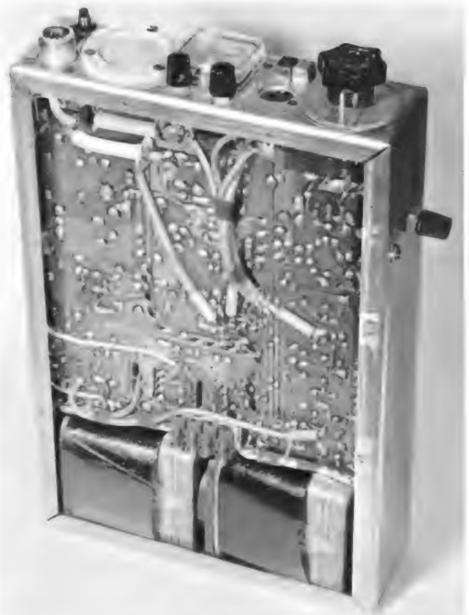
Bild 5. Gehäuse offen von hinten gesehen. Man erkennt die Verdrahtung der Platte und den Batteriekasten
