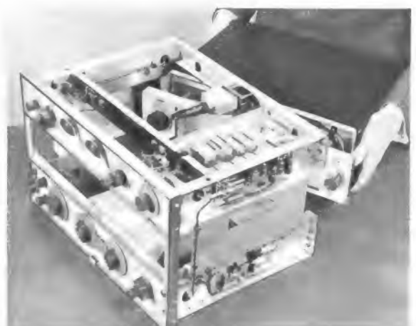
Links: Bild 3. Ansicht des Hf-Teiles von unten bei abgenommenen Deckplatten. Man erkennt die zentrale Antriebsachse für die Abstimmung mit den Oszillator-Schaltplatten (links) und den Ausgangsfilter-Schaltplatten (rechts)
