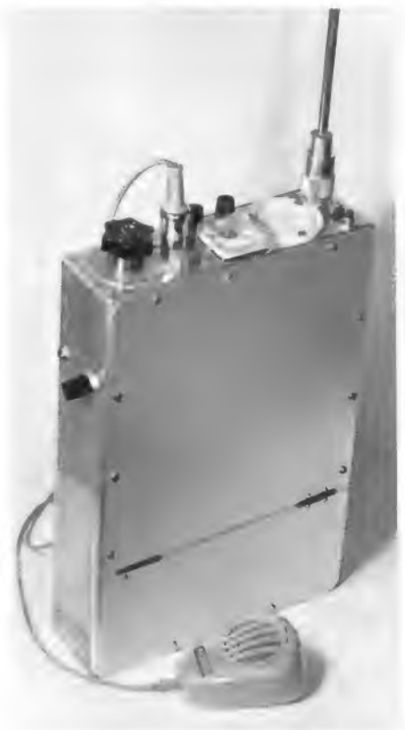
Bild 1. Die fertige Station mit dem Mikrofon und der Stabantenne. Gehäusemaße 175 mm × 255 mm × 51 mm
