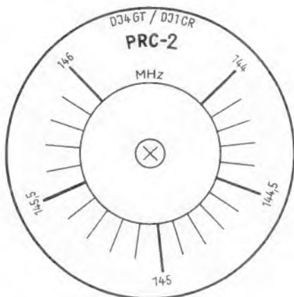
Bild 9. Die Skala mit einer linearen Einteilung von 144...146 MHz, Durchmesser 45 mm
