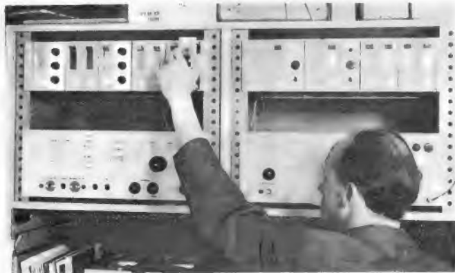
Der kleine werkseigene Grundig-Stereo-Sender im Entwicklungslabor Fürth. Ein Techniker wechselt einen Codierungsbaustein aus
