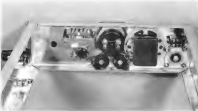
Bild 7. Rückseite der Frontplatte. Die Maßskizze zeigt Bild 8. Das Loch links nimmt die Achse des Drehkondensators auf
