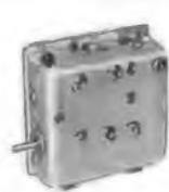
**UHF-Converter-Tuner** mit 2 Transistoren AF 139, zum Einbau in FS-Geräte der deutschen, französischen und US-Norm. Er dient zum Empfang von UHF-Sendern im Bereich von 470-880 MHz. Die Abstimmung erfolgt kapazitiv und nahezu frequenzlinear. Unter-setzter Antrieb 1 : 0,5. Antenneneingang: 240 Ω. Antennenausgang: 60 Ω (Kanal 3 oder 4, 64-68 MHz) 43.-
