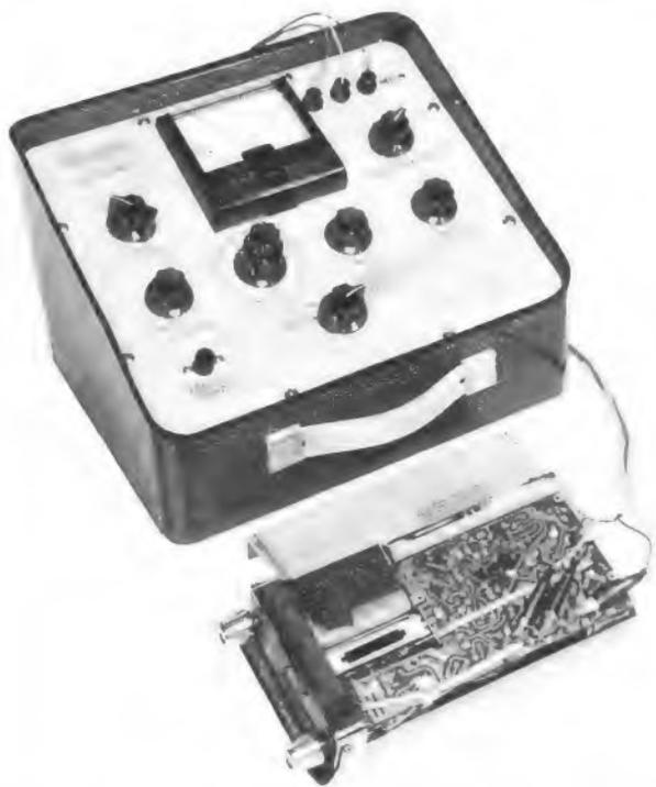
**HICKOK-Transistor-Prüfgerät**, zum Prüfen von Transistoren, auch in der Schaltung! Der Transistor braucht dazu nicht erst ausgelötet zu werden. Bestimmen lassen sich Wechselstrom-Beta und die Transistor-Eingangsimpedanz, ferner die Schaltungs-Eingangsimpedanz. Dieses batteriebetriebene Gerät mißt mit 5% Genauigkeit.
