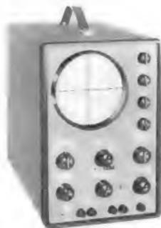
Universal-Oszillograph mit 3stufigem Gegentakt-Gleichspannungs-Verstärker großer Empfindlichkeit. Kompensierter 4stufiger Abschwächer, 12,5 cm Kathodenstrahlröhre, direkte Anschlußmöglichkeit der Vertikalplatten, Rücklaufaustestung und Synchronisationswählschalter, Rechteckvergleichsspannung. Lochblechgehäuse grau mit Frontrahmen. Technische Daten: Vertikal: 3,5 mV/eff cm, 0-500 kHz
