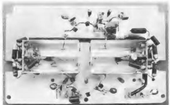
Bild 8. Aufbau des Transistor-Verstärkers FTH 452 (Astro). Er verstärkt selektiv je einen Kanal im Bereich IV und V; Antennenweichen sind nicht erforderlich
