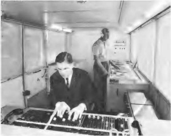
Blick in den Stereo-Übertragungswagen des Süddeutschen Rundfunks. Vorn das Stereo-Misch- und -Steuerpult mit Richtungsreglern und -mischen
