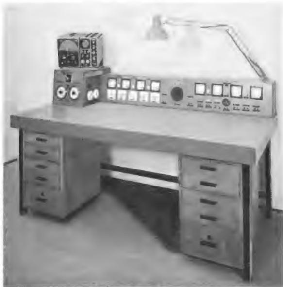
Bild 5. Ensslin-Prüftisch mit Hera-Meßaufbau
