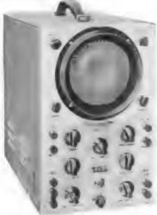
12,5-cm-Bildröhre mit Fluorchtrasterschibe und kontinuierlicher Helligkeitsregelung, Strahlverschiebung horizontal und vertikal, Rücklaufaustestung, Helligkeitsmodulationsanschluß, Eichspannung, 50 Hz und Sägezahnaustritt. Technische Daten: Vertikal: Gleichspannungs-Gegentaktverstärker 0-5 MHz (verwandelbar bis 10 MHz) 10 mV/cm, 4fach frequenzkomp.
