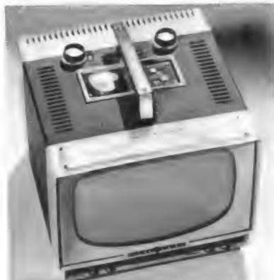
Bild 3. Antennen-Meßgerät von Loewe Opta mit Anzeigeteil und Eichkurve auf der Oberseite
