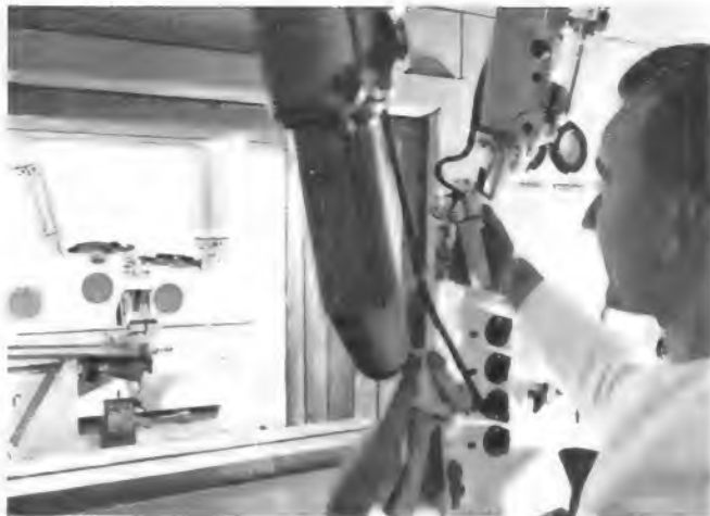
Bild 2. Wie gewaltige Hummerscheren arbeiten die hinter einer mehrfachen strahlungs-sicheren Glasabschirmung betätigten Manipulatoren an hochradioaktiven Präparaten
