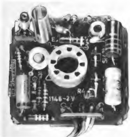
Bild 10. Separate Platine mit Transistor für die Video-Endstufe und Bildröhrenfassung (Blaupunkt)
