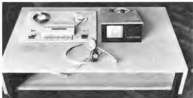
Bild 2. Der Diaprojektor am Schülerplatz (rechts) ist versenkbar konstruiert
