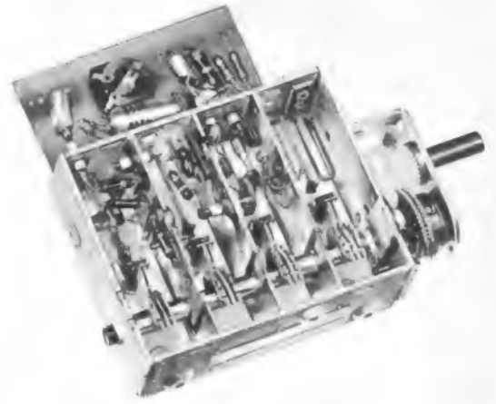
Bild 5. UHF-Tuner mit vier 1/4-Kreisen von Graetz
