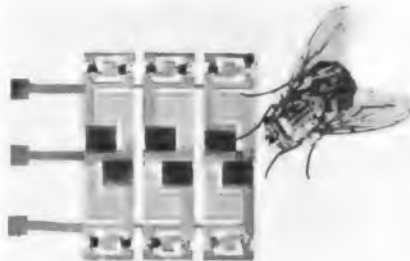
Bild 10b. Dünnschichtschaltungen der SEL im Größenvergleich zu einer Stubenfliege. Jede der sechs Generatorschaltungen enthält zwei Transistoren, einen Widerstand und einen Kondensator
