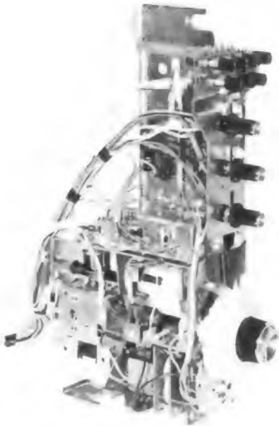
Bild 4. Abstimmblock „Monomat de Luxe“ mit sechs Stationsdrucktasten, Motorabstimmung und Fernprogrammwahl-Einrichtung (Grundrig)
