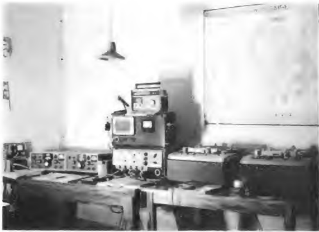
Bild 2. Behelfsmäßiger Empfangs- und Tonaufzeichnungsplatz des Relaisenders Kigali der Deutschen Welle (Mitte 1964). Die Station übernahm im Ballemfang Programme aus Köln
