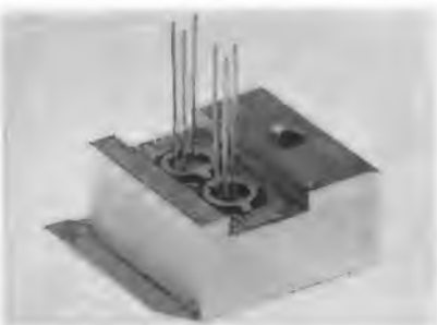
Rechts: Bild 9. Übertragungsloser Transistor-10-W-Verstärker mit Gegentakt-B-Endstufe nach Valvo-Unterlagen
