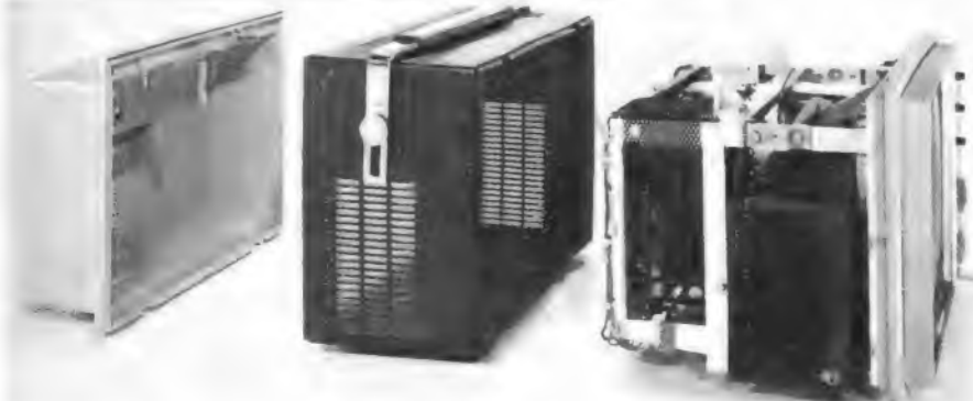
Unten: Bild 12. Die schalenförmig abziehbaren Gehäuseteile des Philips-28-cm-Fernsehempfängers Fernseh-Philetta
