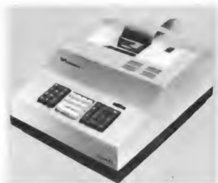
Bild 8. Der elektronische Tischrechenautomat Conti der Wanderer-Werke AG ist mit Druckwerk ausgestattet
