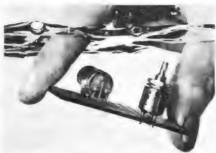
Bild 1. Die drahtgemickelten Miniatur-Potentiometer Typ B 12 B tragen ein Tauchbad (TWK-Elektronik)
