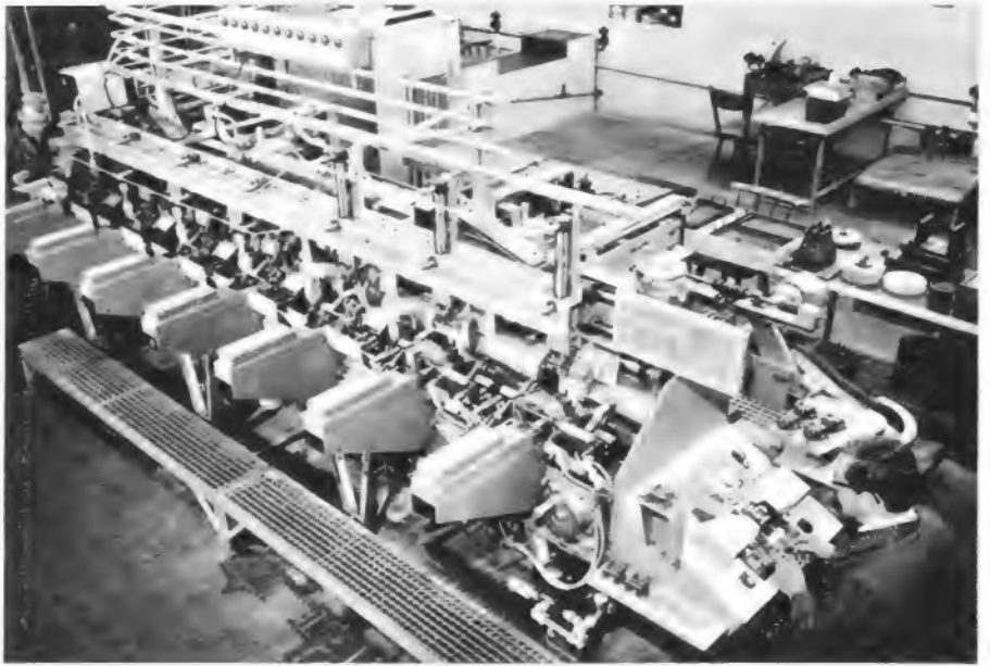
Bild 5. Schleifautomat für die Endbearbeitung von Tonköpfen
