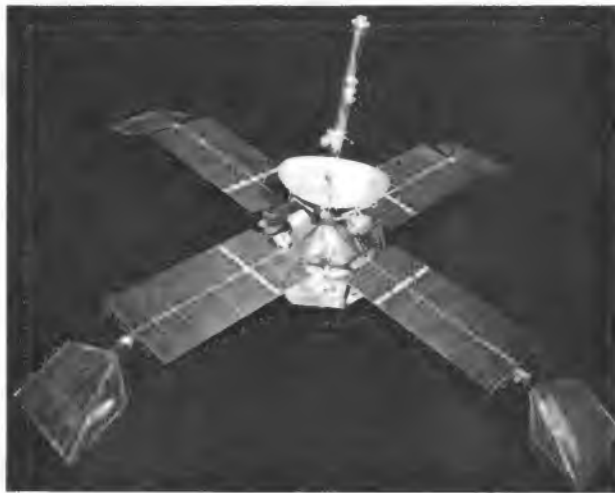
Bild 1. Marsonde Mariner IV mit den vier großen Solarzellen-Trägern und daran befestigten „Wedeln“ zum Messen des Lichtdruckes
