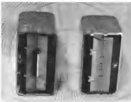
Bild 6. Stereo-Kombiköpfe vor (links) und nach der Endbearbeitung
