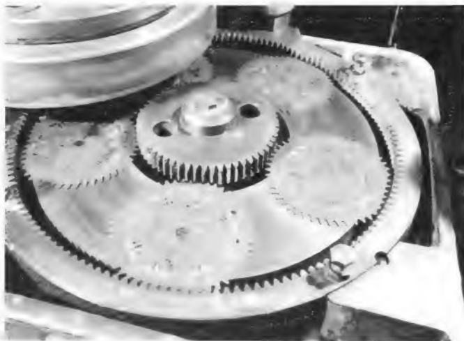
Bild 2. Läppmaschine für Kernbleche im Grundig-Werk 11
