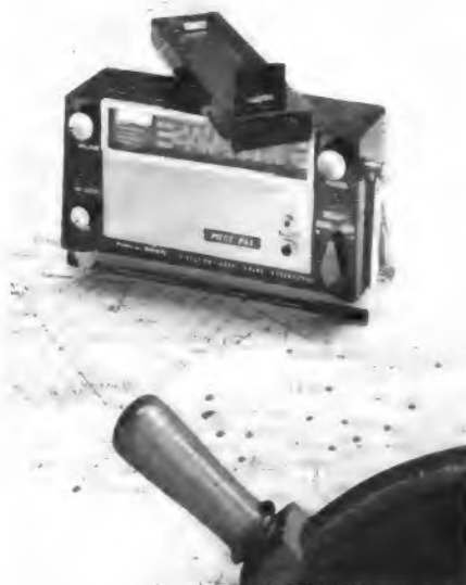
Bild 1. Peilempfänger Pilot Pal mit acht Transistoren, drei Wellenbereichen und Ferritpeilantenne (die Gesamtschaltung Bild 2 findet sich auf der folgenden Seite)
