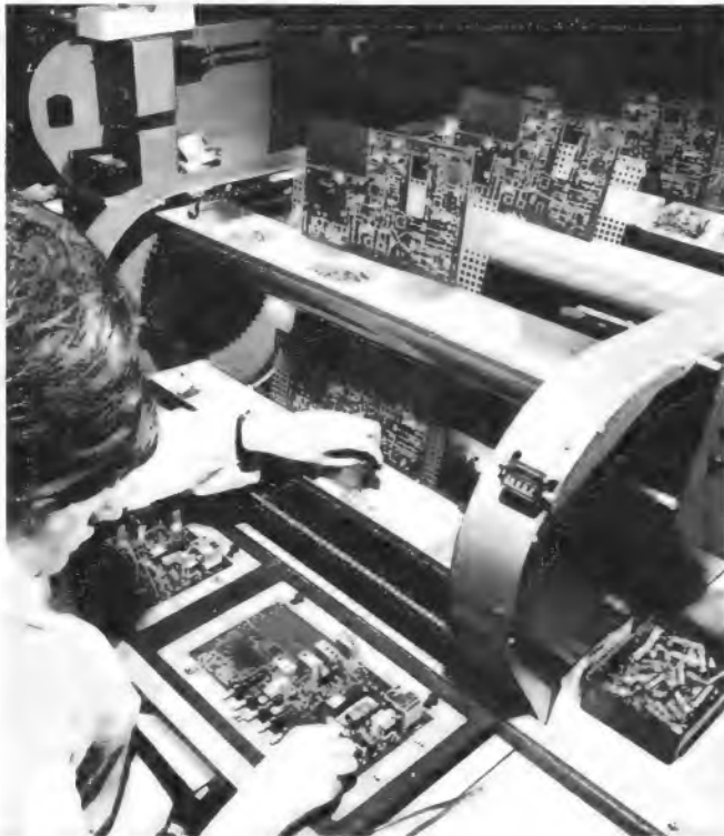
Im Gegensatz zur Fließbandmontage, bei der jede Arbeiterin stets gleichbleibende Handgriffe verrichtet, werden an diesem Arbeitsplatz die Platinen von einer Mitarbeiterin vollständig bestückt
