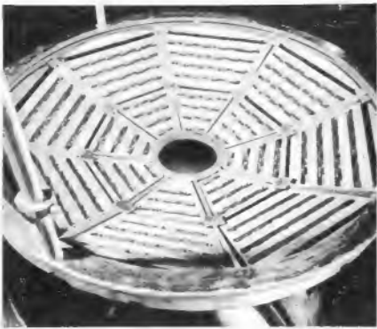
Bild 4. Vakuumlöcke zum Herstellen von besonders feinen Kopfspalten durch einen Aufdampfprozeß
