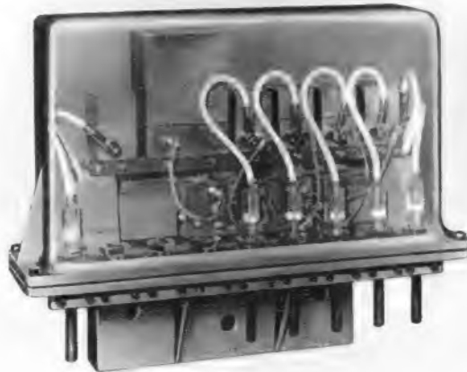
Bild 3. Blick in das Abzweiggehäuse mit Fernspeiseweichen, Leitungsentzerrer, Leistungsverstärker, Spannungsversorgung mit automatischer Stabilisierung und Grundstücksanschlüssen
