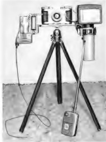
Bild 2. Die für Fernauslösung vorbereitete Kamera; im Vordergrund ist der kleine Handsender zu sehen
