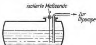
Bild 66. Die isolierte Meßsonde bildet mit dem Absaugrohr eines Öltanks einen Kondensator, er dient als kapazitiver Meßwertaufnehmer
