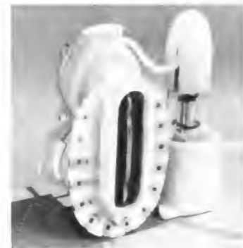
Rechts: Bild 2. Zeilentransformator und Hochspannungsgleichrichter (Orega)
