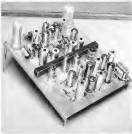
Bild 3. Versuchsaufbau eines Zf-Teiles mit Secam-Decoder (S. A. Vidéon)
