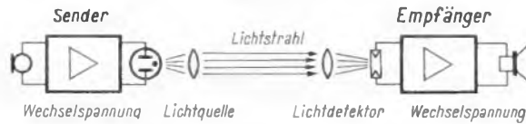
Bild 1. Prinzip eines Lichtsprechgerätes, mit dem Entfernungen bis zu einigen Kilometern überbrückt werden können
