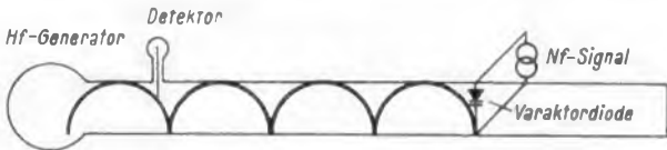
Bild 1. Phasenverschiebung einer stehenden Welle mit Hilfe einer Varaktordiode. Das NF-Signal bewirkt dabei eine Phasenmodulation
