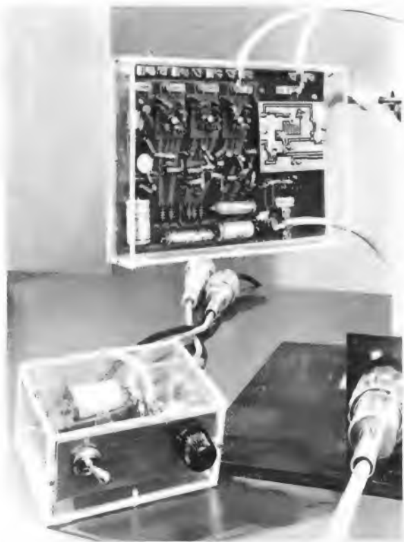
Rechts: Bild 13. „Nichts dreht sich, nichts bewegt sich“ in diesem für vier oerschiedene Bereiche durchstimmbaren Modell eines Antennenverstärkers oben im Bild. Das Bedienungskästchen unten links enthält den Stromversorgungsteil und ein Abstimpotentiometer. Eine besonders interessante Teilkonstruktion stellt die Stufe für den Bereich IV oben im Bild dar. Die Leitungskreise sind nicht räumlich aufgebaut, sondern sie wurden in Druckplattentechnik aus der Kupferfolie herausgeätzt. – Telefunken führte dieses neuartige Modell im Februar d. J. auf einer Fachpresstatung in Berlin vor
