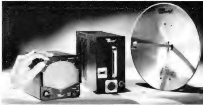
Bild 1. Wetterradaranlage für kleine Flugzeuge (Modell RDR-100 von Bendix). Von links: Monitor mit umschaltbarem Bereich 20/80 Meilen, Sender/Empfänger, 30-cm-Parabolspiegel
