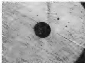
Bild 2a. Ein beim Lötten abgespritztes Tröpfchen eines korrosionsfreien Flußmittels
