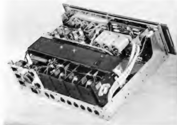
Links: Bild 2. Verstärker-rückseite. Hinter der Frontplatte die Leiterplatten der Vor- und Hauptverstärker sowie das Potentiometerfeld. Über dem Netz- und Modulationsanschlußfeld die Kühlwinkel mit den Endtransistoren
