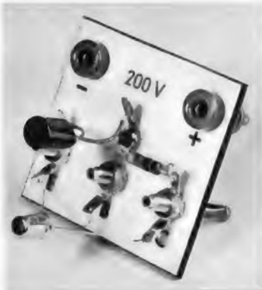
Bild 29. Wird der Transistor als Schalter betrieben, so zeigt die auf das Steckerplättchen neben dem Transistor mit aufgelötete Signalglimmlampe seinen jeweiligen Schaltzustand an. Die Schaltung ist in Bild 30 dargestellt
