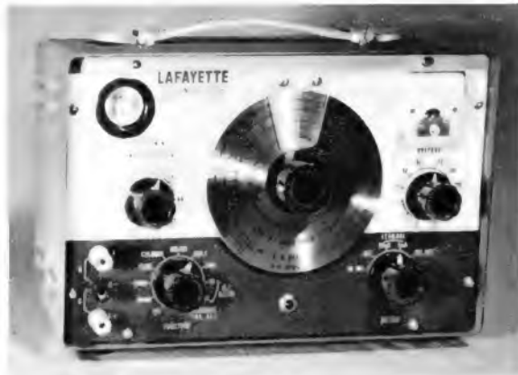
Bild 1. Frontansicht der Lafayette-Meßbrücke TE-46
