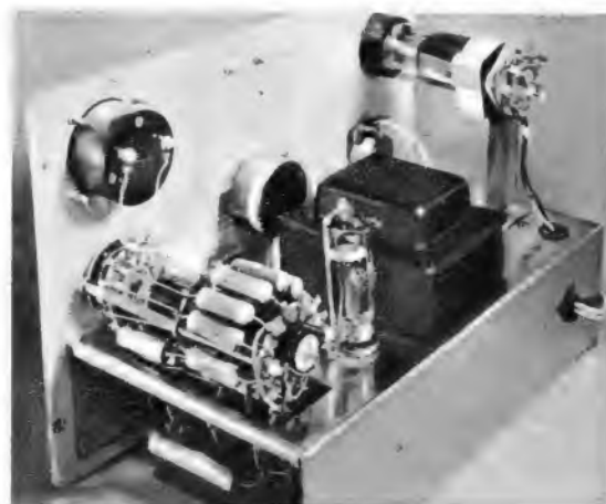
Bild 8. Innenaufbau der Meßbrücke
