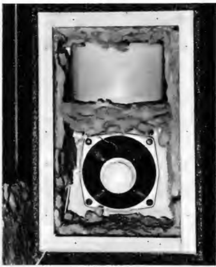
Bild 5. Geöffnete Lautsprecherbox LB 24, untere Füllung teilweise herausgenommen, im endgültigen Zustand ist der Hauptlautsprecher gänzlich zugesperrt
