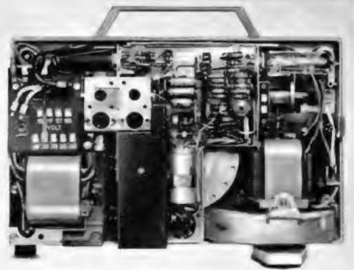
Bild 2. Der geöffnete Projektor: links der Netzteil, in der Mitte der Verstärkerbaustein, rechts der Antriebsmotor
