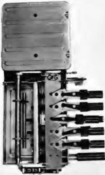
Bild 2. Einblock-Tuner von Blaupunkt mit Tastensatz. Die Einstellung auf den Bereich wird durch Drehen der Tastenhülsen vorgenommen und die Abstimmung auf den Sender mit Hilfe der Spindeln in den Tastenhülsen
