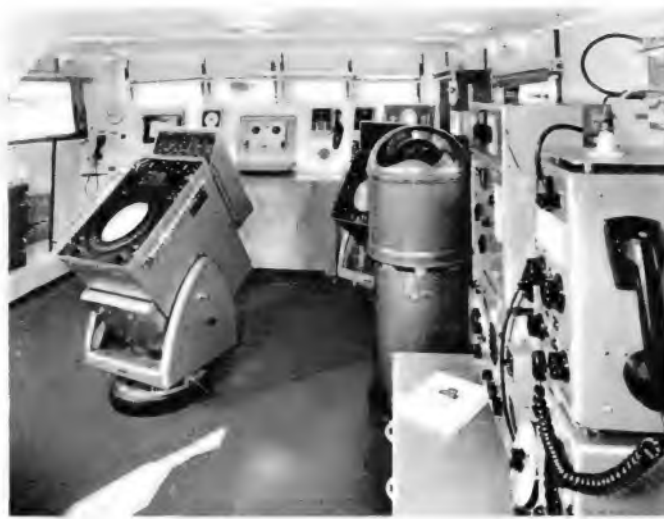
Der Vorführraum auf dem Marconi-Versuchsschiff Eletttra III. Links vorn: Argus-Radar mit True-Motion-Anzeige, hinten (von links nach rechts): Bord-sprechanlage, Echolot mit Schreibgerät, Tiefenanzeiger mit direkter Ablesung in Fuß, Lodestar-Peiler, VHF-Funksprechgerät, Chernikoff-Log, Hermes-Radar, ganz rechts vor dem Kompaßgehäuse zwei Schiffssender mit Empfänger
