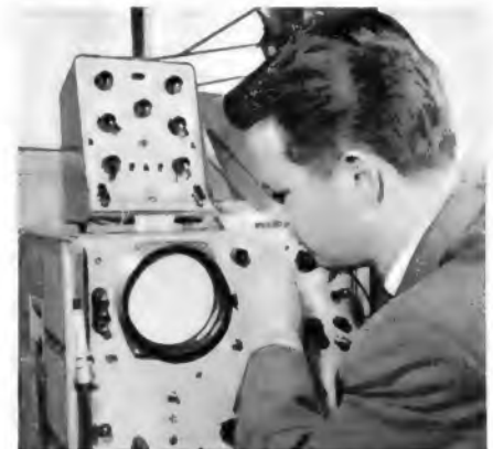
Der Elliott-Transistor-Kennliniensreiber, im Bild oben, arbeitet in Verbindung mit dem darunter befindlichen normalen Labor-Oszillografen
