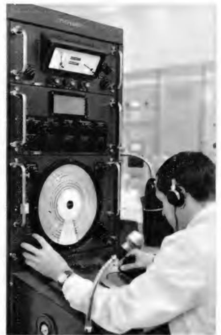
Bild 3. Telefunken-Sichtpeiler in der Meß- und Empfangsstation Bockhacke der Deutschen Welle. Die gemessene Einfallrichtung wird auch zur Einstellung der Antennenrichtcharakteristik benutzt
