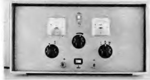
Bild 1. Die Frontansicht des Speisegerätes zeigt oben in der Mitte den Schiebeschalter S 3 zum Umschalten von Vollbetrieb auf Sparbetrieb. Die Drehknöpfe betätigen von links nach rechts den Netz-Einschalter (S 1), die kontinuierliche Spannungseinstellung (R 1) und die Spannungsbereiche (S 2). Unten zwischen den Anschlußbuchsen sitzt ein Schiebeschalter (S 4) für die wahlweise Masseverbindung der positiven oder negativen Ausgangsklemme
