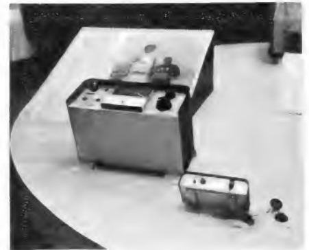
Bild 1. Herzschlag-Fernmeßgerät. Vorn der vom Athleten zu tragende Kleinstsender, links das Empfängergerät für den Sportarzt mit großem in Pulsschläge/min gezeichnet Instrument
