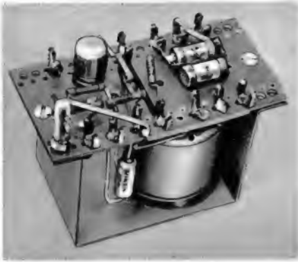
Bild 4. Der Impulsgenerator mit dem Mikrofonvorverstärker. Das kleine Chassis ist in dem Kästchen untergebracht, das als Fuß für das Mikrofon dient
