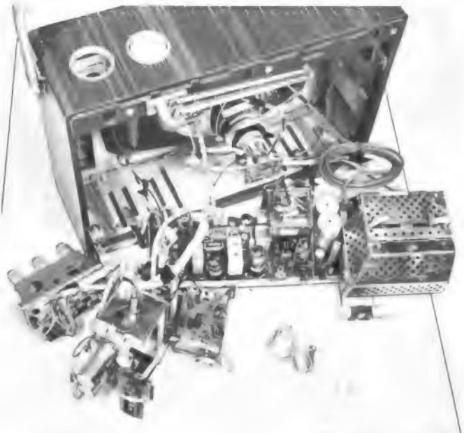
Rechts: Bild 10. VHF-Kanalwähler, UHF-Tuner und alle Teilchassis ausgebaut. Die Länge der Anschlußleitungen reicht für das Arbeiten in der Werkstatt aus
