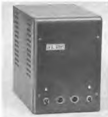
Bild 1. Außenansicht des Netzgerätes. Ausreichende Belüftung gewährleistet Schlitze im Boden, an den Seiten und an der Rückwand
