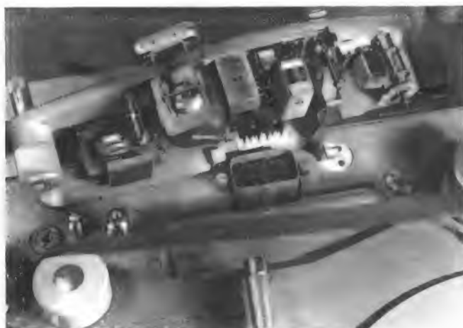
Bild 1. Kopfträgerplatte des Magnetfilmgerätes M 5/16 für bildsynchrone Tonaufnahmen (Telefunken)
