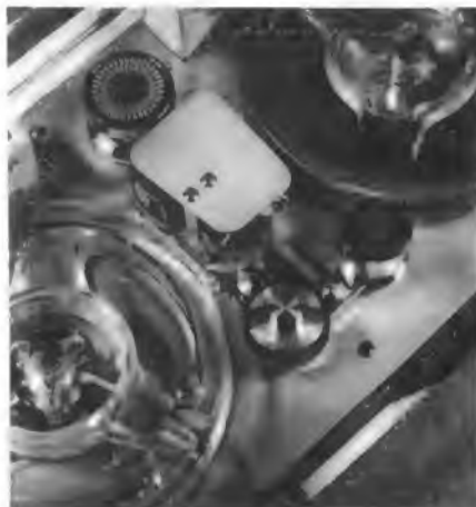
Bild 4. Das Reporter-Tonbandgerät Stellavox SM 5 ist mit einem Pilottonkopf ausgerüstet, der eine bildsynchrone Steuerfrequenz aufzeichnet (EMT Wilhelm Franz KG)
