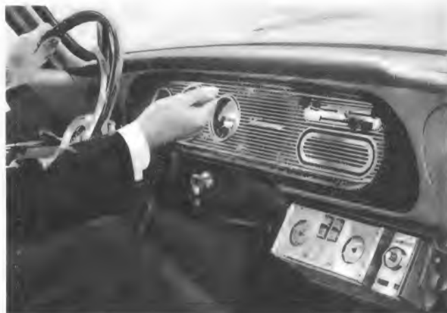
Bild 1. Das Sabamobil wird in eine ähnliche Autohalterung wie für einen Reiseempfänger eingeschoben. Die Bedienungsknöpfe sind leicht zugänglich, und der Kassettenwechsel ist ohne hinzusehen möglich.
