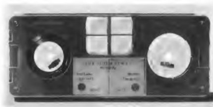
Bild 3. Das Tonband wird in der Kassette dreimal geführt, so daß sich keine Schlaufen bilden können. Die Spulen liegen lose und zentrieren sich beim Aufsetzen selbst
