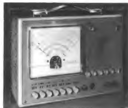
Röhrenvoltmeter W 22 von Funke. Meßbereiche und Betriebsarten sind übersichtlich jeweils in einer Zeile abzulesen und durch Tasten zu schalten. Das Instrument besitzt Skalen für Effektivwerte und Spitze-Spitze-Werte
