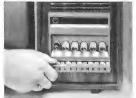
Bild 1. Kompaktabstimmung im Empfänger FE 344 T. Unten: herausziehbares Fach mit Einstellern, oben: Trommelskala, in der Mitte: sechs leichtgängige Drucktasten für alle Bereiche
