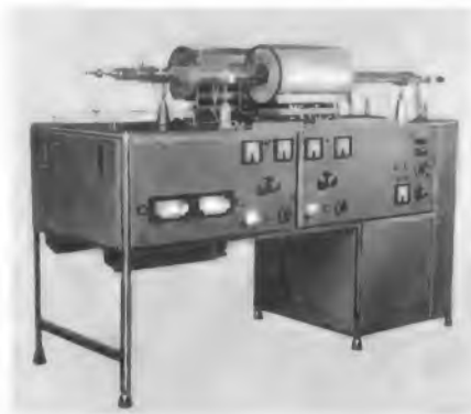
Bild 5. Diffusionsanlage mit Ein- und Zweizonenoptionen für die Halbleiterfertigung
