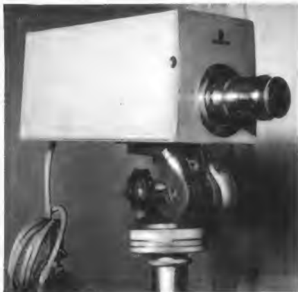
Bild 3. Kompaktkamera mit Lichtwertautomatik (Siemens)
